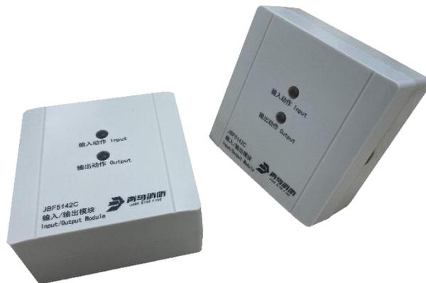
JBF5142C 输入/输出模块(以下简称模块)是青鸟消防股份有限公司开发的可实现脉冲输出、持续输出两种输出方式的控制模块。该模块主要用于消防联动设备的控制,并可接收联动设备动作后的应答信号从而判断被控设备是否动作,同时可对被控设备与模块的输入端和输出端连接线路状态进行监测。在使用过程中消防联动控制器发出命令,通过输入/输出模块启动或停止与该模块连接的外部设备,同时监测外部设备工作状态。
