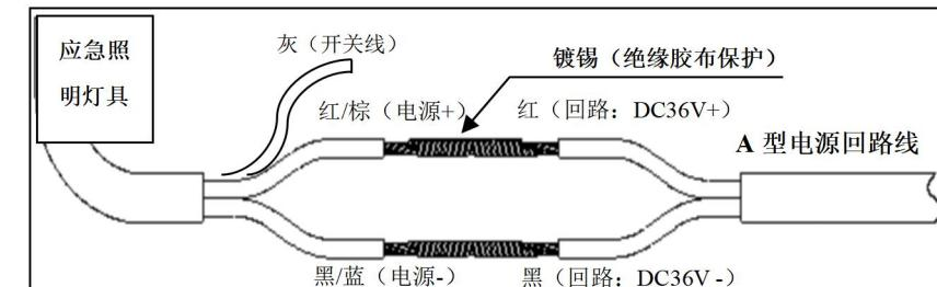
灯具出厂自带一根强启线（灰色），灯具如需兼做日常照明，可通过在回路线正极上加装开关来实现控制，如果单个开关要控制多个灯具则将各灯具强启线并联至开关下端，如上图所示。
